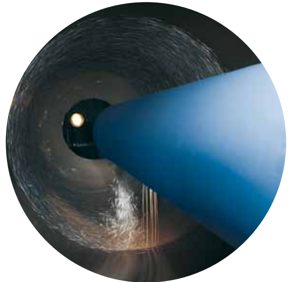
Von HOBAS patentiertes Schleuderverfahren
