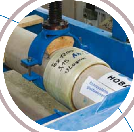
Prüfung der Abwinkelung in den Kupplungen
