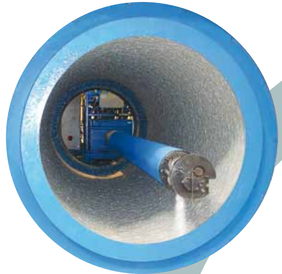
Von HOBAS patentiertes Schleuderverfahren
